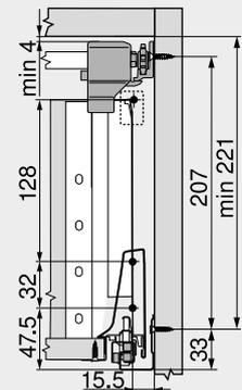
Posición de atornillado – estabilizador lateral
