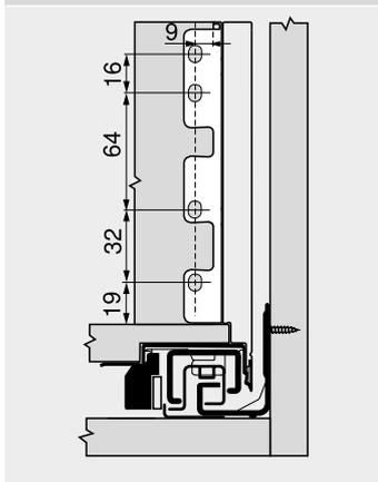
\* +1 mm si las guías de cuerpo se instalan antes de montar el cuerpo
