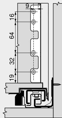
\* +1 mm si las guías de cuerpo se instalan antes de montar el cuerpo
