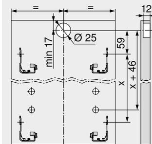
\* +1 mm si las guías de cuerpo se instalan antes de montar el cuerpo
