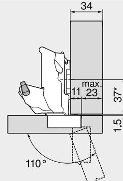
Bisagra para recubrimiento angular
