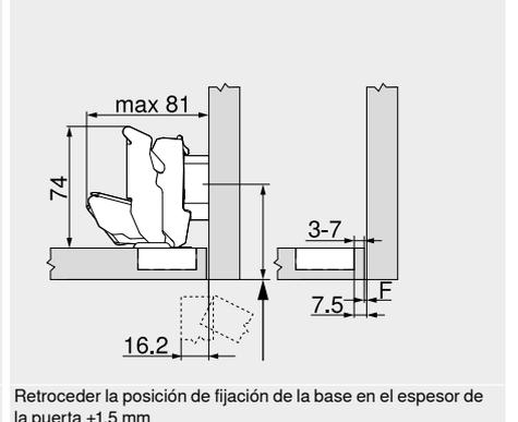
Retroceder la posición de fijación de la base en el espesor de la puerta +1.5 mm
