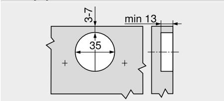
**Montaje INSERTA | por encaje a presión**
